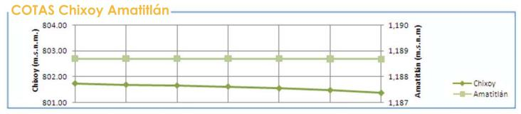
La cota de Chixoy presenta un valor de 801.74 a 801.37 m.s.n.m. con una variación de -0.37 m. La cota de Amatitlán presenta un valor de 1,188.7 a 1,188.68 m.s.n.m. con una variación de -0.02 m. Cota de rebalse de Chixoy: 803 m.s.n.m.
